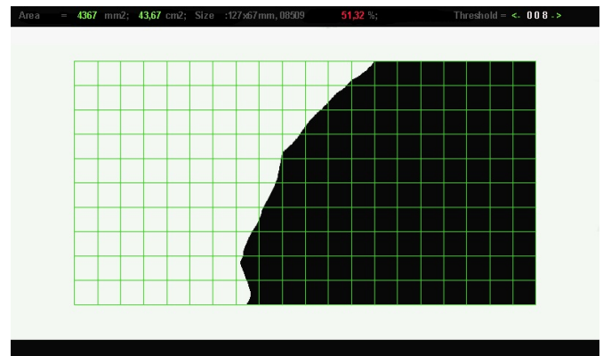
Автоматическое измерение площади (остаточной площади) банкноты
