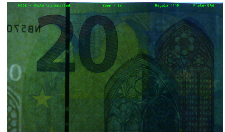
Фрагмент исследуемой банкноты в белом донном свете. Увеличение на мониторе 2 крат
