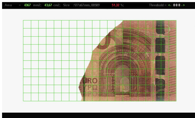
Автоматическое измерение площади (остаточной площади) банкноты
